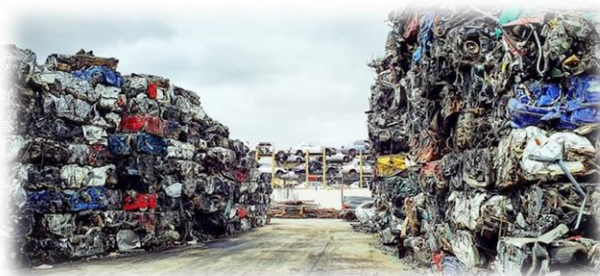
Paquetes para el reciclado de chatarra en hornos de fundición.
